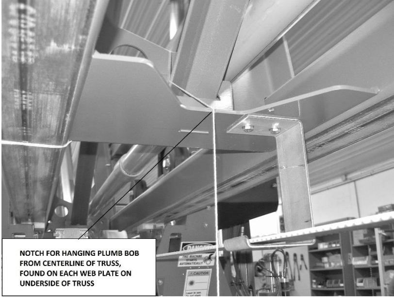
**NOTCH FOR HANGING PLUMB BOB FROM CENTERLINE OF TRUSS, FOUND ON EACH WEB PLATE ON UNDERSIDE OF TRUSS**
